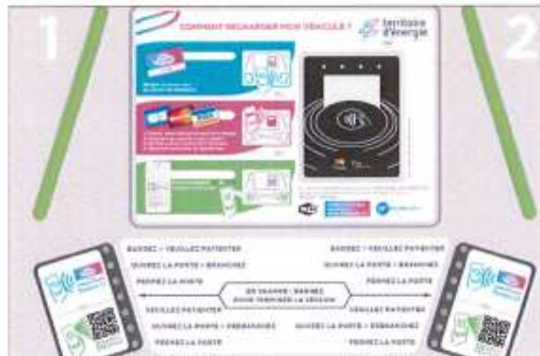
Exemple de sticker décrivant les 3 solutions possibles pour se connecter sur un point de charge : Badge RFID, carte bleue sans contact ou Smartphone.
